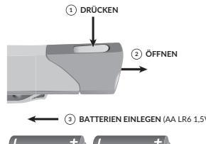
Zum Batteriewechsel muss die Batteriekappe geöffnet und nach dem Einlegen der Batterien wieder aufgesetzt werden (siehe Abbildung). Ein notwendiger Batteriewechsel wird durch 3-maliges Blinken der LED und ein 3-maliges Ertönen des akustischen Signals angezeigt. Verwenden Sie keine Akkus (wiederaufladbare Batterien).
