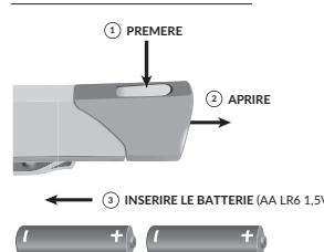
Per sostituire le batterie aprire la calotta del vano batterie e richiederla una volta inserire le batterie nuove (v. figura). Quando è richiesta la sostituzione delle batterie il LED lampeggia tre volte, con contemporanea tripla segnalazione acustica. Non utilizzare batterie ricaricabili.
