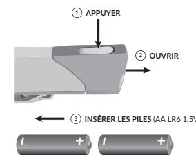
Pour changer les piles, ouvrez le cache et remettez-le en place après avoir inséré des piles neuves (voir l'illustration). Les piles doivent être changées lorsque le voyant lumineux clignote 3 fois et le signal sonore se fait entendre 3 fois. N'utilisez pas d'accumulateurs (piles rechargeables).
