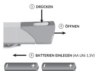
Zum Batteriewechsel muss die Batteriekappe geöffnet und nach dem Einlegen der Batterien wieder aufgesetzt werden (siehe Abbildung).
