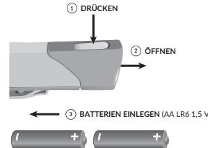
Zum Batteriewechsel muss die Batteriekappe geöffnet und nach dem Einlegen der Batterien wieder aufgesetzt werden (siehe Abbildung).
