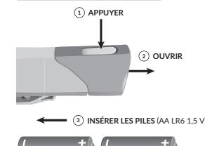
Pour changer les piles, ouvrez le cache et remettez-le en place après avoir inséré des piles neuves (voir l'illustration).
