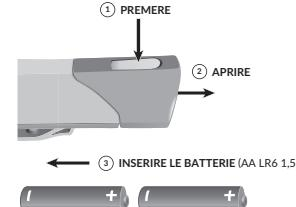
Per sostituire le batterie aprire la calotta del vano batterie e richiuderla una volta inserite le batterie nuove (v. figura). Quando è richiesta la sostituzione delle batterie il LED lampeggia tre volte, con contemporanea triplice segnalazione acustica. Non utilizzare batterie ricaricabili.
